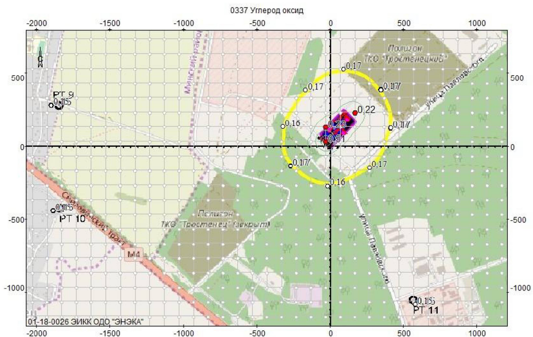
Объект: 102, Мусоросортировочный завод; вар.исх.д. 1; вар.расч.1; пл.1(h=2м) Масштаб 1:22100
