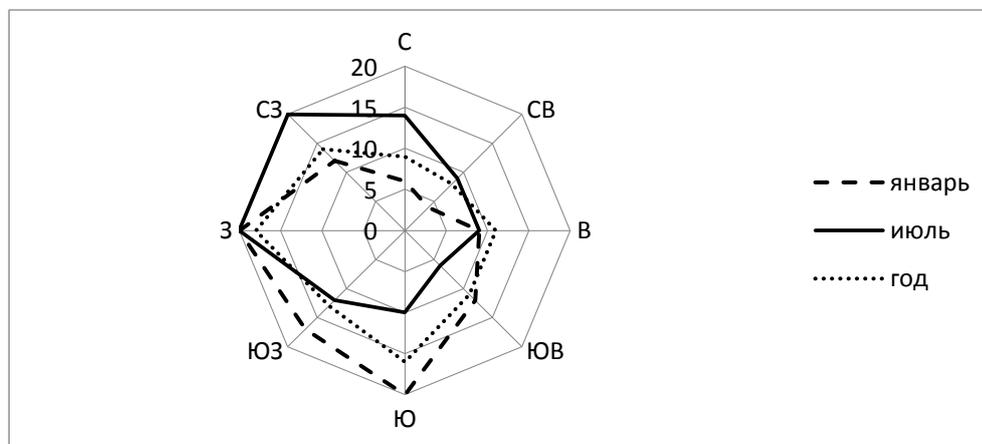
Рисунок 5 - Графическое построение розы ветров в районе расположения проектируемого объекта
