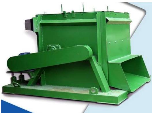
Аналог мод. Измельчитель БТМ-1М представляет собой мобильную электрическую установку, предназначенную для измельчения в крошку отходов кровельных битумосодержащих материалов, отходов товарного битума с последующим рассевом продуктов дробления, образованных в процессе хозяйственной деятельности предприятий и предназначен для производства продукции «Крошка битумосодержащая» на которую в свою очередь должны быть разработаны технические условия.
