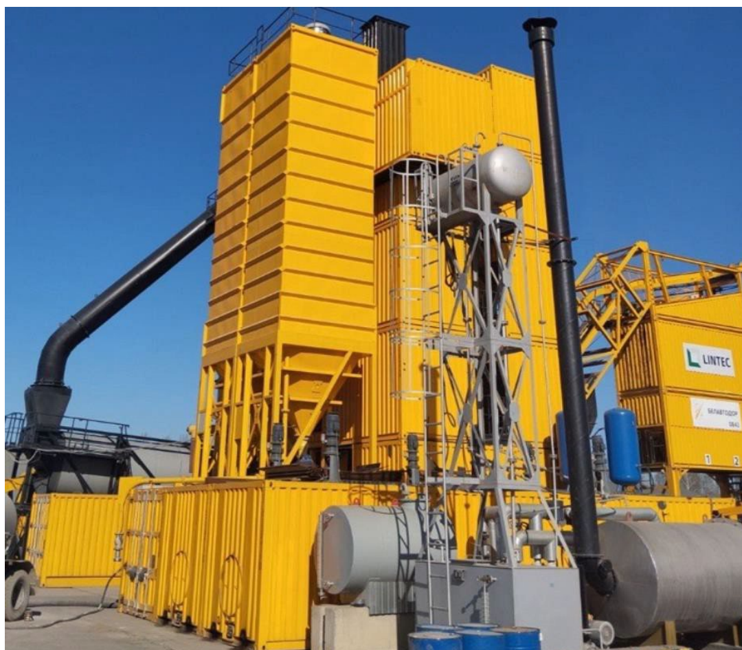
Рисунок 2 – Внешний вид асфальтосмесительной установки контейнерного (блочного) типа Lintec CSM 3000/6
